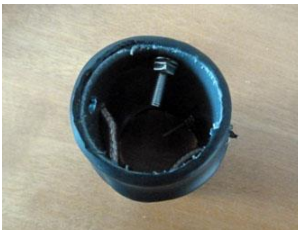
Von innen ist alles wetterfest. Der Antennendraht wird mit Kabelschuhen an die Schrauben angeschlossen.
