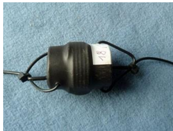
Mit Schrumpfschlauch ist auch von außen alles wetterfest. Zur Zugentlastung wird der Antennendraht durch zwei Löcher geführt.
